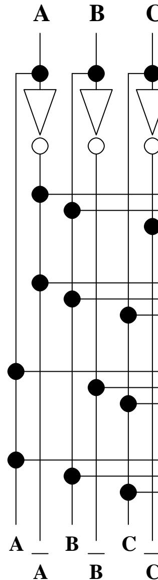
$$F = \overline{A} \cdot B \cdot \overline{C} + \overline{A} \cdot \overline{B} \cdot C + \overline{A} \cdot \overline{B} \cdot \overline{C} + A \cdot \overline{B} \cdot C$$
